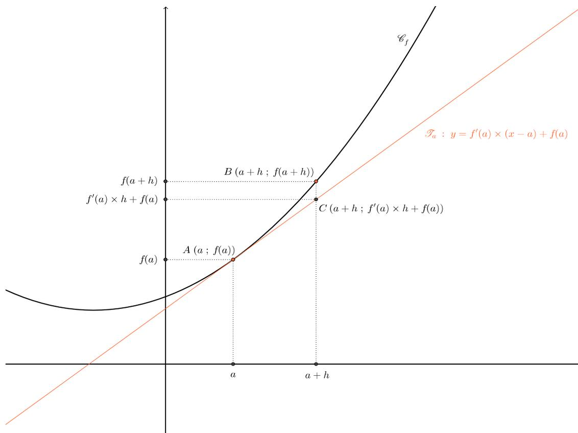
Si la fonction  $f$  est dérivable en  $a$ , on va pouvoir approcher  $f(a+h)$ , c'est-à-dire l'ordonnée du point  $B$  sur la figure, par  $f'(a) \times h + f(a)$ , c'est-à-dire l'ordonnée du point  $C$  sur la figure ( $C$  est le point d'abscisse  $a+h$  situé sur la tangente  $\mathcal{T}_a$ ). Cette approximation est une approximation affine. Elle sera d'autant meilleure que  $|f'(a)|$  et  $h$  seront « petits ».
