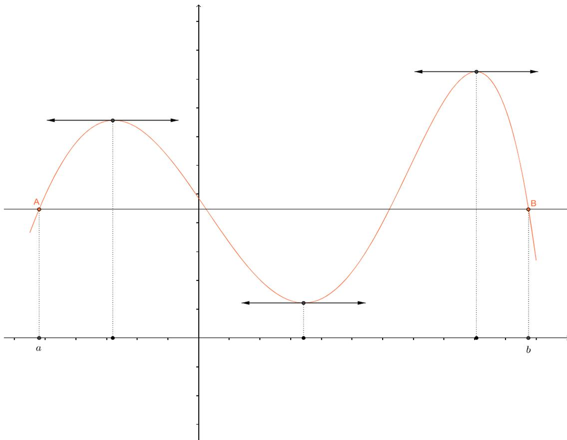
Sur la figure ci-dessus, les points A et B ont la même ordonnée ( $f(a) = f(b)$ ) et la fonction dérivée  $f'$  s'annule trois fois sur l'intervalle  $]a ; b[$  (cf. les tangentes horizontales).
