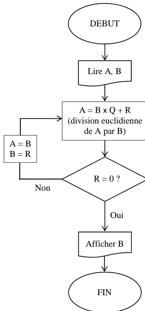
Au niveau de la mise en œuvre de cet algorithme simple, on peut ajouter à la lecture des variables A et B un test pour garantir, avant d'entrer dans la boucle principale, que les nombres saisis sont bien des entiers non nuls (cf. l'algorithme AlgoBox fourni ci-après).
